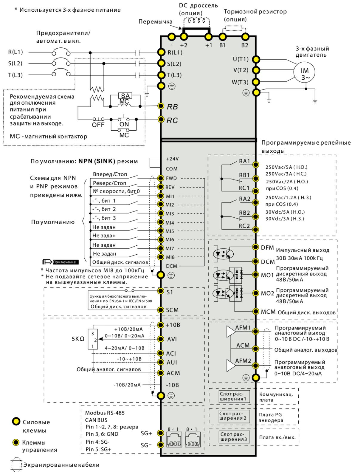
Рис.1. Входные клеммы для типоразмеров G и H
