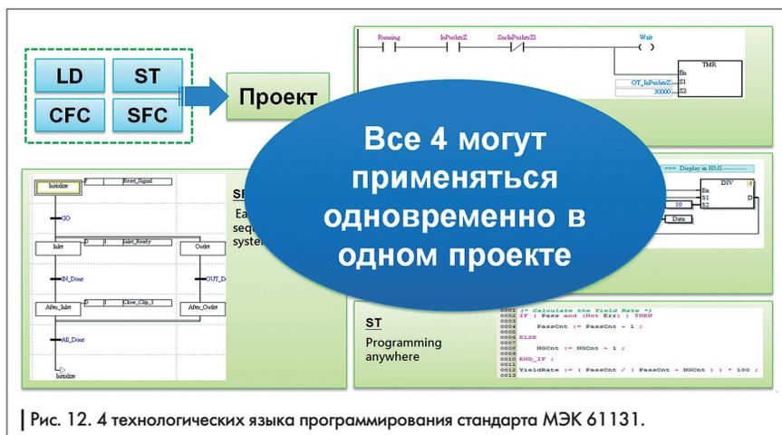
Рис. 12. 4 технологических языка программирования стандарта МЭК 61131.
