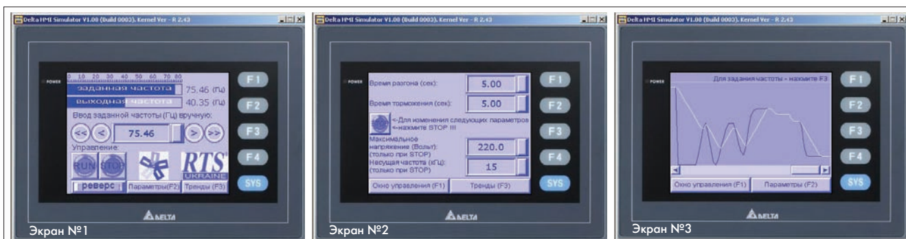
Рис. 3. Режим симуляции On-Line (то есть, с подключением компьютера, на котором стоит «ScreenEditor» и который имитирует собой поведение операторской панели, к реальному оборудованию) позволяет окончательно отладить программу, до загрузки ее в реальную операторскую панель
